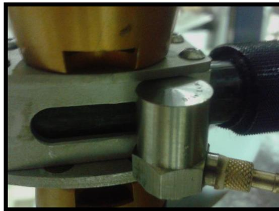
Figura 65: Acelerómetro acoplado ao sistema de propulsão coaxial otimizado
