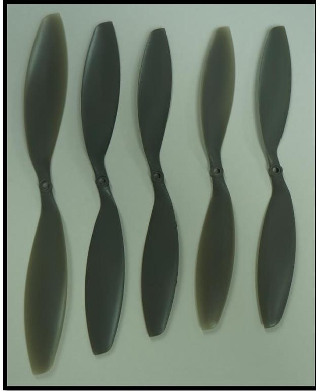
Figura 19: Hélices utilizadas nos ensaios experimentais
