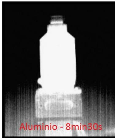
Figura 24: Imagem térmica do motor com uma chapa de fixação em alumínio
