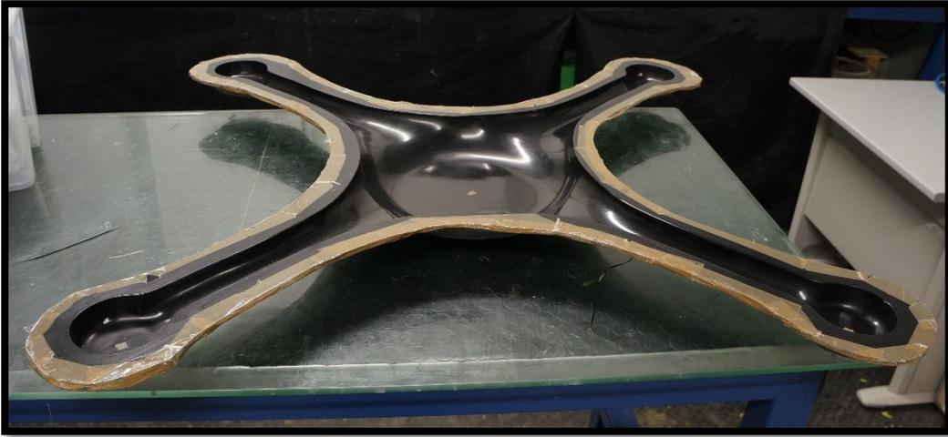
Figura 48: Molde da estrutura do quadcopter *Spyro*
