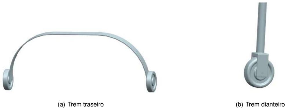
Figura 5.9: Modelo CAD do trem de aterragem.
