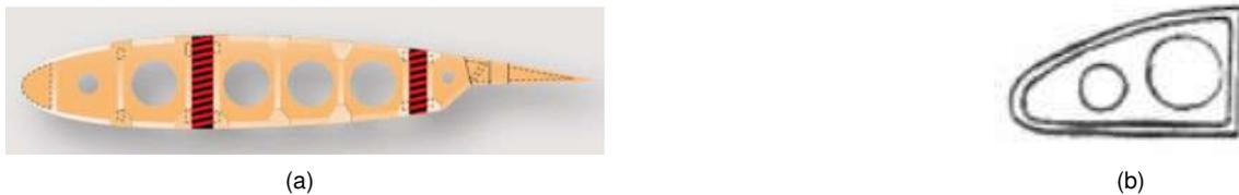
Figura 2.4: Configurações de nervuras: (a) verdadeira, Aircraft Systems Tech (2021); (b) falsa, Fernandes (2008).
