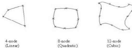
Figura 2.9: Elementos finitos quadriláteros 2D, Siemens (2019b).
